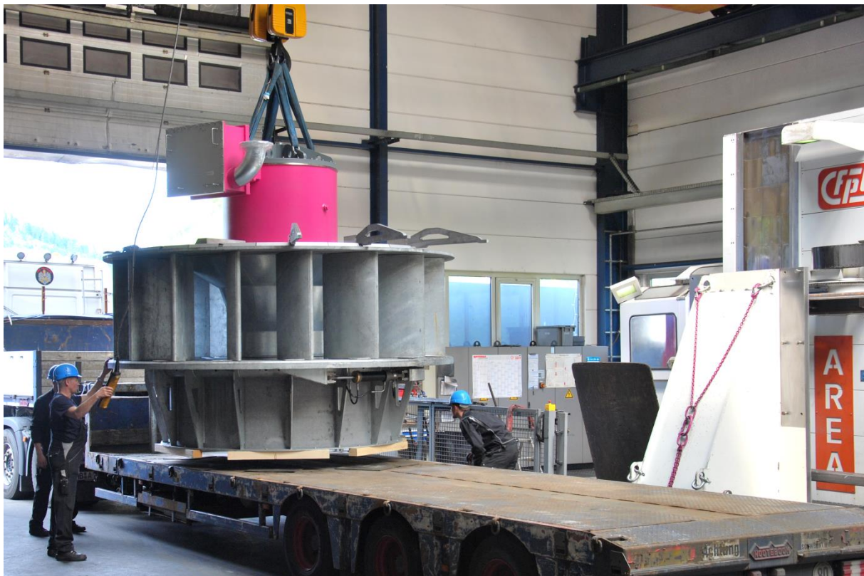
Verladung der ersten von drei Turbinen in der Fertigungshalle
