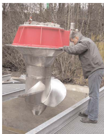
Die modulare Bauweise der Maschine trägt auch wesentlich zu einer kostengünstigen Errichtung bei. Im Bild oben: das Einheben des Leitapparats. Rechts: Die DIVE-Turbine: Laufrad und Generator sind zu einer kompakten Einheit verschmolzen.
